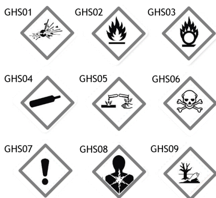
Slika 3.4-6. GHS Piktogrami nevarnosti v GHS sistemu ( angl. Globally Harmonised System) razvrščanja in označevanja kemikalij (povzeto in prirejeno po United Nations).
